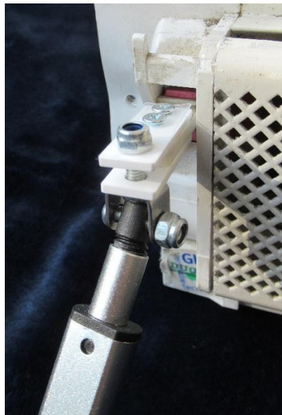
Aansluiten van de 2 witte plaatjes op de handle en kop van de actuator met behulp van de actuator klem (metaal).
